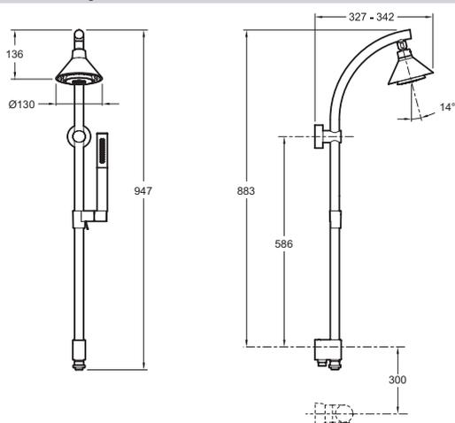
Спецификация продукта: Душевая колонна с верхним душем Moxie 127 мм + беспроводной динамик. E8078. Коллекция: MOXIE. ВЕС: 4,1 кг. НАЛИЧИЕ СМЕСИТЕЛЯ: БЕЗ СМЕСИТЕЛЯ. Выпускное отверстие с антиизвестковым покрытием.
