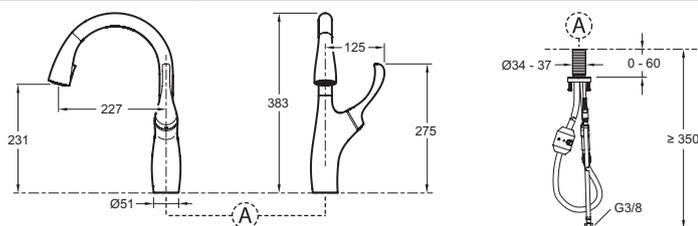
Спецификация продукта: Смеситель для кухни. E72511. Коллекция: SUZANNE. ТИП УСТАНОВКИ: 1 отверстие. РАСХОД ВОДЫ: 7 л/мин. ВЫСОТА ПОД ИЗЛИВОМ: 383 мм. ПОДКЛЮЧЕНИЕ: С гибкой подводкой. МЕХАНИЗМ: Керамический картридж.
