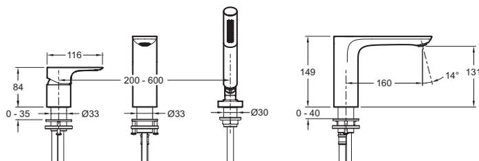
Descriptif CCTP : Mitigeur bain-douche - 3 trous sur gorge. E72292. Collection : ALEO. POIDS : 5,1 kg. NORMES ET RÉGLEMENTATIONS : ACS : 15 ACC LY 216. DÉBIT (L/MN SOUS 3 BARS) : 22 l/mn. SAILLIE DU BEC (MM) : 160. RACCORDS : Avec raccords colonnettes. MÉCANISME : Cartouche à disques céramique. MITIGEUR DE BAIN : MECANIQUE. INVERSEUR : Inverseur automatique verrouillable. GARANTIE MÉCANISME : 5 ans. TYPE DE FLEXIBLE : Flexible lisse anti-torsion. Inverseur automatique intégré.
