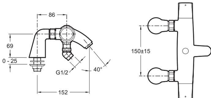
Спецификация продукта: Смеситель для ванны/душа, устанавливаемый на деку. E18875. Коллекция: ELEVATION. ВЕС: 3,4 кг. РАСХОД ВОДЫ: 21 л/мин при давлении 3 бар. МЕХАНИЗМ: Кран-буксы с керамическим диском. РАЗМЕТКА ОТВЕРСТИЙ: 150 мм.
