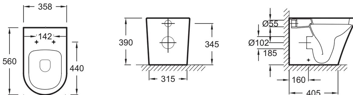
Спецификация продукта : Приставной унитаз без обода. EDAA102. Коллекция : RODIN+. РАЗМЕРЫ (CM) : 56 x 36 см. ВЕС : 28 кг. МАТЕРИАЛ : Огнеупорная керамика. ТИП УСТАНОВКИ : Напольные. CONSOMMATION D'EAU : Экономия воды: 2,6/4 л. HAUTEUR : Стандартные. TYPE DE BRIDE : Без обода. MÉCANISME DE CHASSE : Двойной смыв. GARANTIE DE LA CÉRAMIQUE : 10 лет. FIXATION DE LA CUVETTE : Скрытые. Плотно прилегает к стене.
