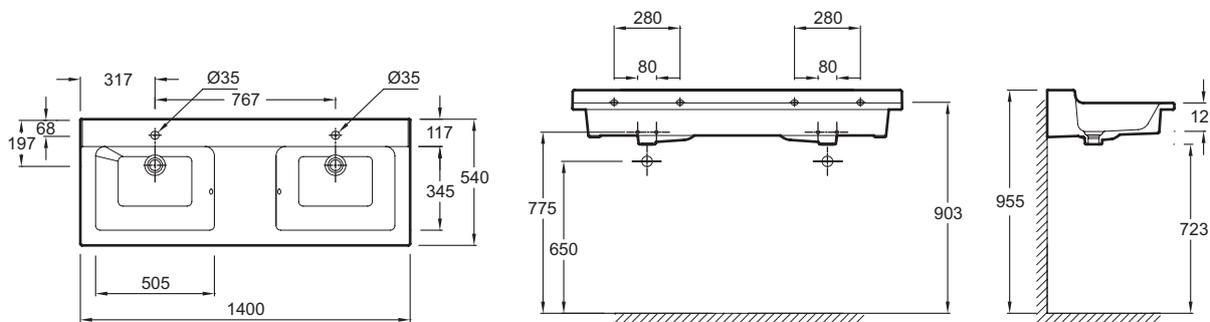
Спецификация продукта: Двойная подвесная раковина-столешница 140 x 54 см. EXJ112. Коллекция: SOPRANO. Размеры (см): 140 x 54 см. Вес: 48,5 кг. Разметка сверления отверстия для смесителя: С 1 отверстием для смесителя у каждой раковины. Дополнительная опция: Опорные ножки и полотенцесушитель. Рекомендуемые смесители: коллекция Talan.
