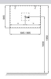
Спецификация продукта: Зеркало 90 см. ЕВ1773. Коллекция: RYTHMIK PURE. PA3MEPЫ (СМ): 89,50 х 6 х 64,50 см. ВЕС: 20 кг. МАТЕРИАЛ: Цельное дерево. ТИП УСТАНОВКИ: Крепление к стене. ВКЛЮЧЕНИЕ: 230В, 7ВТ, класс II IP44. ФИКСАЦИЯ: Установщику понадобится набор крепежей для монтажа на стену.
