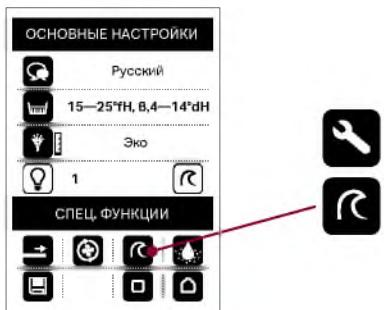
Термическую очистку унитаза-биде можно запустить вручную, без напоминания от устройства.
