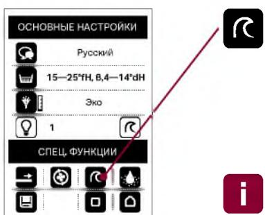
С помощью термической очистки вся водопроводящая система унитаза-биде промывается горячей водой и очищается от бактерий и микроорганизмов. Нажмите кнопку «Термическая очистка», чтобы перейти в меню. Соответствующие указания на пульте дистанционного управления помогают выполнить эту программу.
