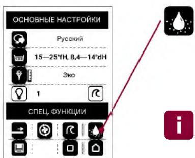
Программа очистки от накипи позволяет удалить накипь из всех водопроводящих компонентов. Нажмите кнопку «Очистка от накипи», чтобы перейти в меню. Соответствующие указания на пульте дистанционного управления помогают выполнить программу очистки от накипи.
