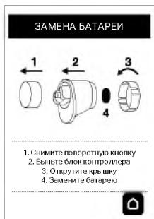
Снимите поворотную кнопку, потянув ее прямо без вращения, и выньте блок панели управления. Откройте крышку батареи, повернув ее влево и вынув прямо. Выньте старую батарею и передайте ее для надлежащей утилизации. Вставьте новую батарею, проследив при этом за правильной полярностью при установке.
