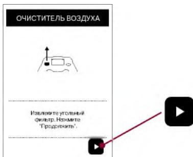
Выньте использованный угольный фильтр вертикально вверх.
