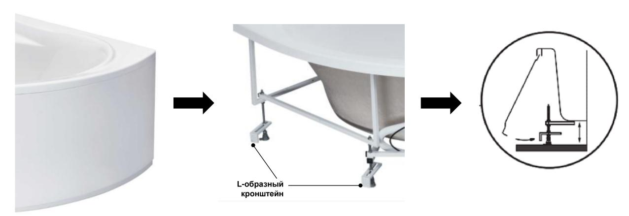
Новый монтажный комплект дополнен специальными L-образными кронштейнами для крепления панели. Шляпка самореза маскируется декоративной заглушкой.
