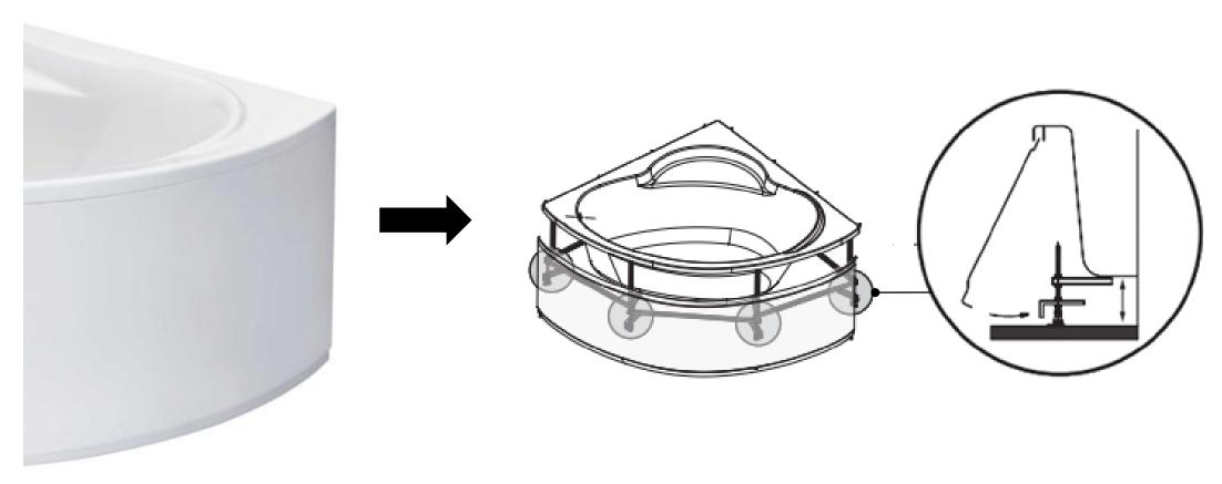
Новый способ крепления панели на саморезы – это наиболее надежный способ крепления для радиусных фронтальных панелей больших размеров.
