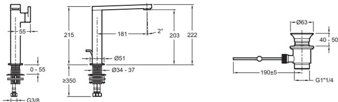
Descriptif CCTP : Mitigeur lavabo - modèle Haut - levier hôtellerie. E73168. Collection : COMPOSED. POIDS : 2,8 kg. NORMES ET RÉGLEMENTATIONS : ACS : 14 ACC LY 511. DÉBIT (L/MN SOUS 3 BARS) : 5 l/mn. HAUTEUR TOTALE DU ROBINET (MM) : 222. SAILLIE DU BEC (MM) : 181. RACCORDS : Avec flexibles d'alimentation. MÉCANISME : Cartouche à disques céramique. TYPE D'INSTALLATION : 1 trou. GARANTIE MÉCANISME : 5 ans. Aérateur anti-calcaire..
