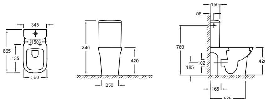
Descriptif CCTP : Cuvette sortie vario SANS BRIDE. UJN102. Collection : VOX. DIMENSIONS : 66,50 x 36 cm. POIDS : 30,7 kg. MATÉRIAU : Céramique. TYPE D'INSTALLATION : Au sol. CONSOMMATION D'EAU : Standard 3/6 L. HAUTEUR : Confort. TYPE DE BRIDE : Sans bride. BRIDE : Sans bride. PRODUIT INCLUS : (réservoir et abattant non inclus). ABATTANT : Non inclus. GARANTIE DE LA CÉRAMIQUE : 10 ans. FIXATION DE LA CUVETTE : Cachées.
